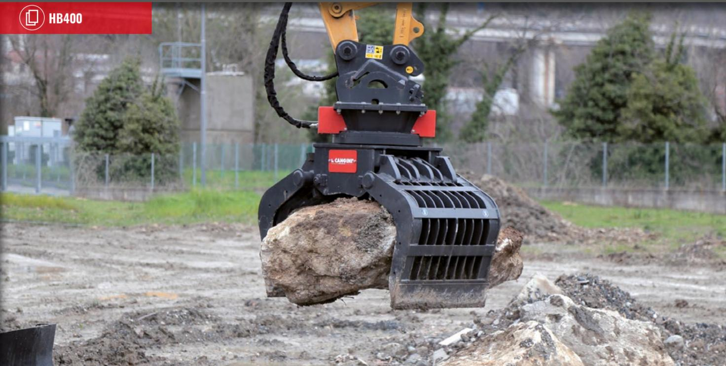
Sortiergreifer mit hydraulischer Dreh- und Greiffunktion. Für Trägergeräte mit Hammerverschöpfung gibt es ein Elektroventil als Zubehör lieferbar. Zum Sortieren diverser Materialien. Die Schalen sind aus HB 400 gefertigt und haben wendbare, verschraubte Schneiden. Dank der besonders robusten Struktur sind auch leichte Abbrucharbeiten möglich.
