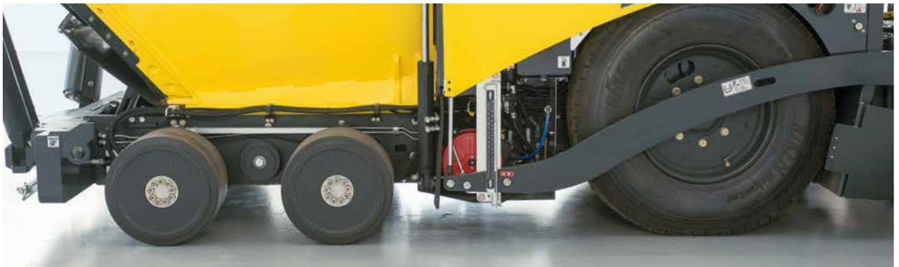
Optionaler 6x6-Radantrieb für maximale Zugkraft.
