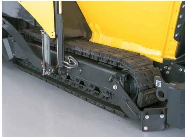
Lange Kettenlaufwerke sorgen für schnurgeraden Einbau.
