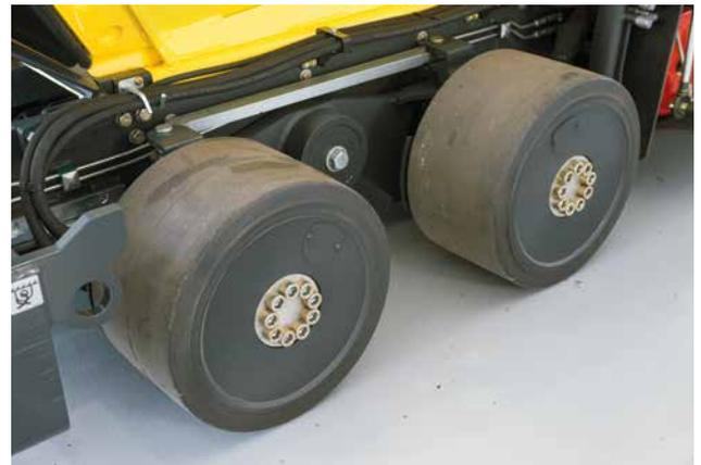
Pendelnd aufgehängte Vorderachse für konstanten Bodenkontakt.
