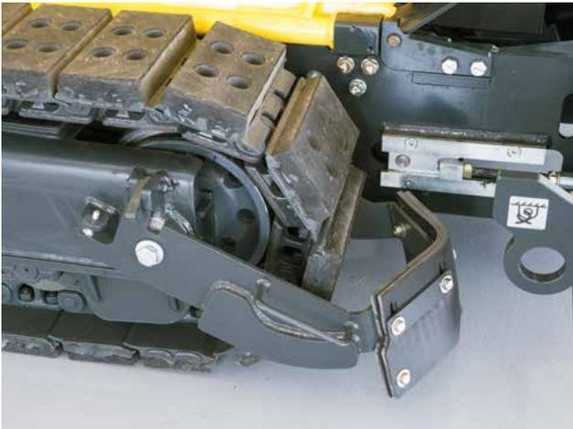
Kettenräumer garantieren einen geringen Wartungsaufwand.
