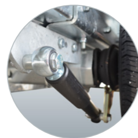
Accessoire ; jeu d'amortisseurs d'essieu
