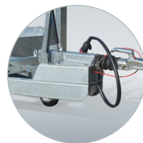
Accessoire ; pièce de rehausse d'attelage 5 ou 10 cm
