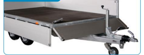
Abnehmbare Bordwände und abnehmbare Eckpfosten ermöglichen eine einfache Beladung.
