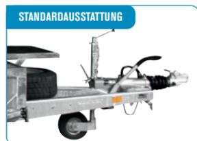
**Kräftiges Stützrad.** 3500 kg mit Rippen. **Kugelkupplung** mit Schloß bei 3500 kg Modellen
