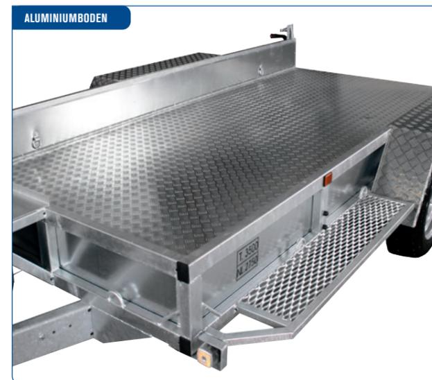
Erhöht die Lebensdauer Ihres Anhängers und ermöglicht eine sichere und rutschfest Hoch- und Runterfahrt.
