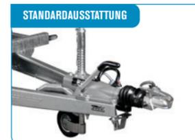
**Stützrad.** Mit Rippen bei 3.500 kg Modellen. **Kugelumkupplung** mit Schloß bei 3.500 kg Modellen.
