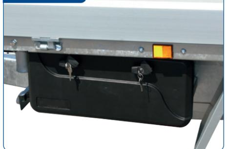
Robuster Werkzeugkasten mit eingebautem Schloss. Für Montage unter der Ladefläche, 55 x 25 x 30 cm (L x B x H).
