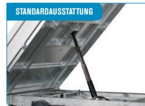
4-Stufen-Stempel sorgt für einen hohen Kippwinkel, sodass Kies, etc. leicht herunterrutschen kann.
