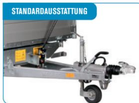
Notpumpe und Stützrad mit Rippen. Kugelkupplung mit Schloß bei 3500 kg Modellen.
