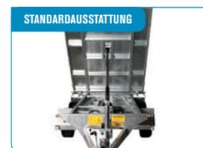
Durchdach robust. Vollverschweißt und verzinktes Fahrgestell sowie verzinkte Deichsel.
