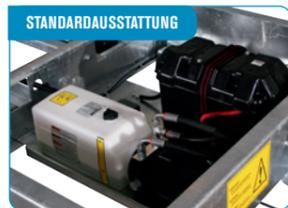
El-hydraulischer Kipp. Komplett mit eingebauter Batterie und Ladegerät.
