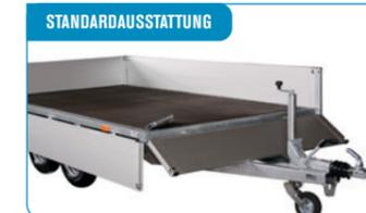
**Abnehmbare Bordwände und abnehmbare Eck- u. Mittelpfosten**, ermöglichen eine einfache Beladung.
