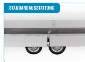
**Klappbare und abnehmbare Bordwände.**
