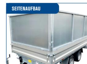
Verzinkter Seitenaufbau in Stahl, oberes Scharnier. Erhöht das Raumvolumen des Anhängers.
