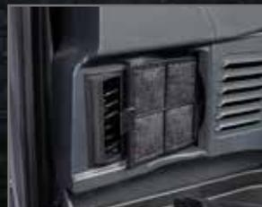
Klimaanlagenfilter für Innenluftzirkulation
