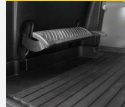
Die hängenden Pedale mit dem kombinierten Brems-Inch Pedal ermöglichen auch bei hoher Motordrehzahl ein feinfühliges Rangieren. Des Weiteren kann der Kabinenboden einfach entnommen und gereinigt werden.
