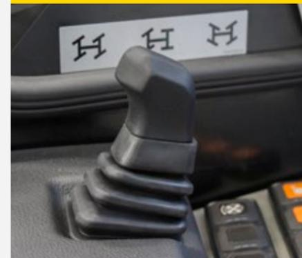
Ein Wechsel zwischen den Lenkungsarten ist mit dem Bedienhebel am Amaturenbrett möglich. Ob Allrad-, Vorderachs- oder Hundeganglenkung, für jede Anwendung gibt es die richtige Lenkungsart.
