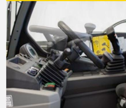
Die Lenksäule und das Lenkrad können je nach Anforderung des Fahrers individuell eingestellt werden, sowohl in der Höhe als auch in der Neigung. Auch beim Ein- und Aussteigen hat der Fahrer dadurch mehr Raumfreiheit. Des Weiteren besteht das Lenkrad aus einem hochwertigen und griffigen Material.
