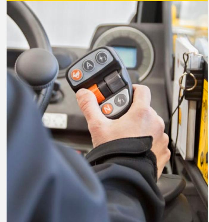
Mit dem ergonomischen Joystick haben Sie die ganze Maschine unter Kontrolle. Mit bis zu 17 Funktionen können die wichtigsten Aufgaben erledigt werden, ohne dabei den Joystick loszulassen oder umzugreifen. Der Joystick ist an der Konsole auf der rechten Kabenseite befestigt.
