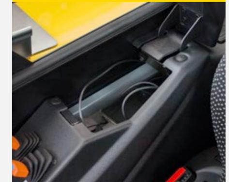
Die Armlehne des Kramer 1445 sorgt nicht nur für zusätzlichen Komfort: Unter der aufklappbaren Lehne befindet sich ein praktisches Staufach mit einer USB Ladebuchse, in dem sich beispielsweise das Smartphone aufbewahren und gleichzeitig aufladen lässt.
