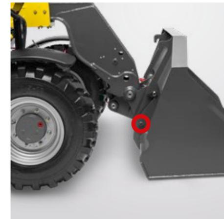
**Hydraulischer Gerätewechsel (optional) - Das Kramer Schnellwechselsystem:** An das Anbaugerät heranfahren, das Anbaugerät vom Fahrersitz aus aufnehmen und per Rolltaster am Joystick hydraulisch verriegeln. Der Verriegelungszyylinder liegt außerhalb vom Drehpunkt der Schnellwechselplatte und ist somit nicht im Schmutzbereich.
