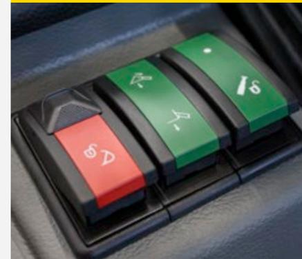
Durch die farblich gekennzeichneten Schalter ist die jeweilige Funktionsgruppe sehr schnell zu erkennen. Rot = Sicherheit, Grün = Hydraulik, Blau = Fahren und Grau = Elektrik. Hierdurch wird dem Fahrer eine bequeme und sichere Bedienung ohne Verwechslungsgefahr gewährleistet. Das Ergebnis ist eine erhöhte Arbeitseffizienz.
