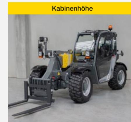
Durch die kompakte und niedrige Bauweise bleibt beim Transport der Maschine die Gesamthöhe unter vier Metern. Die kompakten Ab- messungen mit einer Breite von nur 1,81 m und einer Höhe von 1,95 m machen die Maschine zu einem un- ersetzlichen Begleiter bei Arbeiten in beengten Platzverhältnissen.
