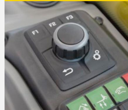
Das optionale Jog Dial dient primär der individuellen Ölmengeverstellung der verschiedenen Steuerkreise. Die Ausgabe erfolgt über das Anzeigeelement und wird prozentual angegeben. Zudem können weitere Einstellungen im Anzeigeelement vorgenommen werden.
