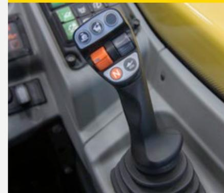
Der elektronisch vorgesteuerte Joystick ermöglicht ein äußerst feinfühliges und präzises Arbeiten sowie die Einbindung von Fahrassistenzsystemen, wie z.B. Smart Handling, welches den Fahrer noch weiter unterstützt. Im innovativen Nachtdesign leuchten die verschiedenen Taster und Räder farbig.
