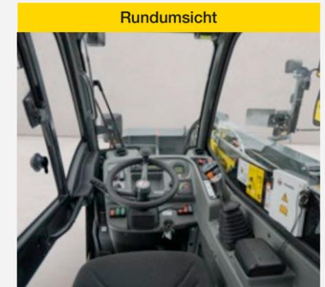
Die zentrale Sitzposition in Verbindung mit den großzügigen Glasflächen bie- ten eine optimale 360°-Rundumsicht. Die besonders übersichtliche Bau- weise des 2205 und die Sitzposition des Fahrers vermeiden „tote Winkel“ - auch nach hinten.
