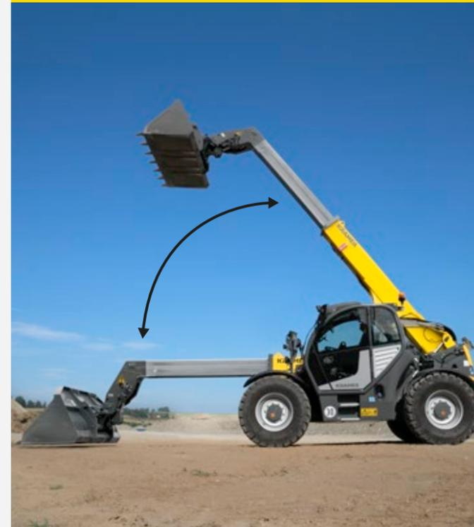
Im manuellen Modus werden von der Maschine keine automatischen Bewegungen der Ladeanlage ausgeführt. Der Überlastschutz ist selbstverständlich weiterhin aktiv und stoppt die Ladeanlage sobald die Überlastgrenze erreicht wird. An diesem Punkt sind nur noch das Einteleskopieren, das Anheben der Ladeanlage und das Auskippen des Anbaugeräts möglich. Aufgrund seiner Klasse besitzt nur der 2706 diese zusätzliche technische Raffinesse.
