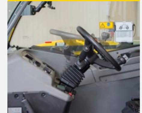
Die Lenksäule ist in der Neigung und Höhe an die Bedürfnisse des Fahrers anpassbar. Durch nach unten drücken des Hebels kann das Lenkrad vor- und zurückgeschwenkt werden. Das Ziehen des Hebels bewirkt eine Verstellung des Lenkrads in der Höhe. Des Weiteren ist das Lenkrad mit einem hochwertigen und griffigen Material bezogen.
