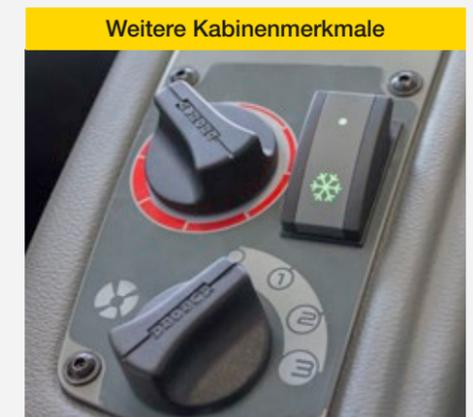
Die optionale Klimaanlage bietet eine bestmögliche Luftverteilung in der Kabine. Durch Filterung der Innen- raumluf wird die Sauberkeit und das Wohlbefinden erhöht. Des Weiteren ist ein hochwertiges Continental Ra- dio mit USB-Anschluss und Blue- tooth-Freisprecheinrichtung optional erhältlich.
