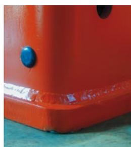
Les tôles préformées évitent les soudures aux coins
