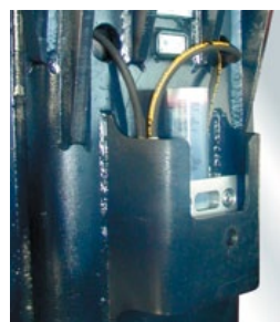
Robustes Schutzgehäuse für die Schmierkartusche
