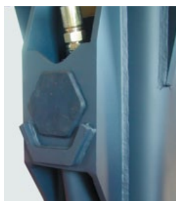
Keine Schraubdeckel, Anschlüsse leicht zugänglich
