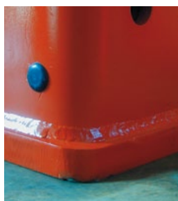
Durch Biegeteile keine Eck-Schweißnähte
