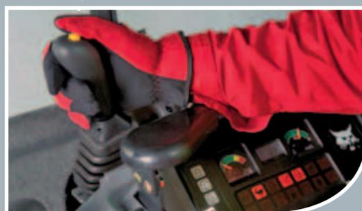
Un troisième manipulateur commande le flottement de la lame et l'activation du changement automatique de vitesse des moteurs de translation pour des conditions de travail particulièrement confortables.
