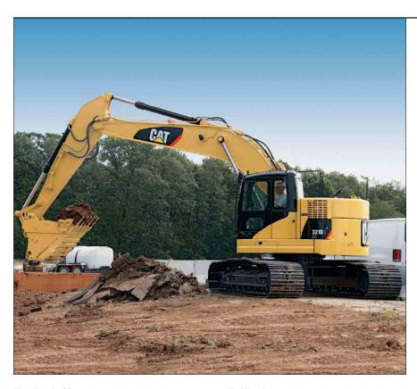
Kurzheck-Oberwagen. Das besonders kurz konstruierte Heck des Oberwagens prädestiniert die Maschine für Einsätze, bei denen wenig Platz zur Verfügung steht – also beispielsweise im Stadtgebiet. Während der Standardbagger 320D einen Heckschwenkradius von 2750 mm aufweist, beträgt dieses Maß beim Kurzheckbagger 321D LCR nur 1680 mm. Dadurch reduziert sich der seitliche Überhang je nach Bodenplattenbreite auf lediglich 186 bzw. 86 mm.
