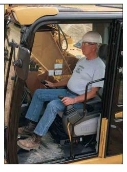
Fahrerkomfort. Die Verkürzung des Oberwagens hat keinerlei negative Auswirkungen auf den Fahrerkomfort, denn der 321D LCR wird mit derselben geräumigen Kabine ausgerüstet wie der Standardbagger.
