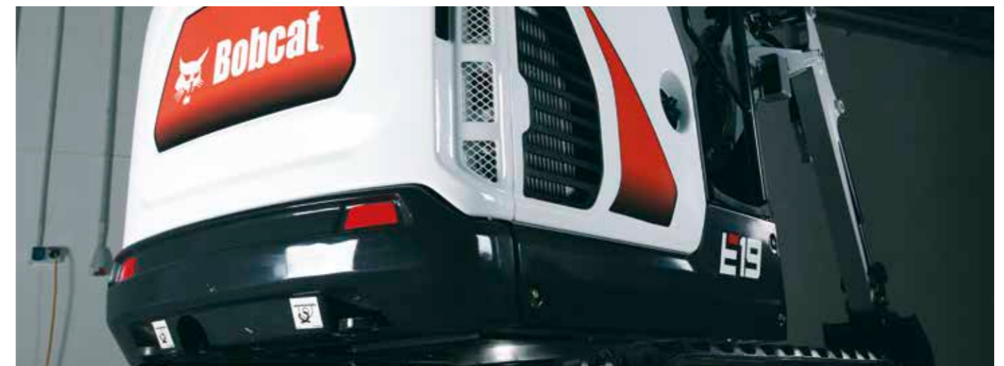
Gegossenes Gegengewicht schützt die Heckklappe
