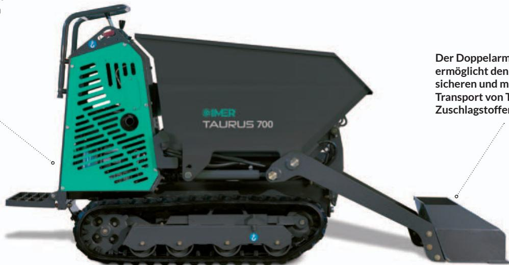
Der Doppelarm-Selbstlader ermöglicht den schnellen, sicheren und mühelosen Transport von Trümmer, Erde, Zuschlagstoffen in die Mulde.
