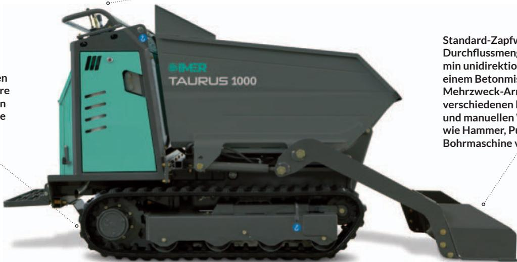
Standard-Zapfwelle mit erhöhter Durchflussmenge von 26 L / min unidirektional. Sie kann mit einem Betonmischer-Kit, einem Mehrzweck-Arm-Kit oder mit verschiedenen hydraulischen und manuellen Werkzeugen wie Hammer, Pumpen und Bohrmaschine verwendet werden.
