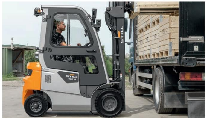
Idéal pour une utilisation en extérieur : avec une garde au sol généreuse et une cabine conducteur fermée en option pour une protection fiable contre les conditions météorologiques difficiles
