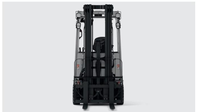
Tout est visible en toute sécurité : le mât triplex à montants fins offre une visibilité optimale et soulève des charges jusqu'à une hauteur de 6,5 mètres
