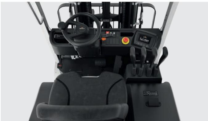
Souplesse et confort : grâce au réglage continu, le siège du conducteur et la colonne de direction peuvent être ajustés rapidement et facilement
