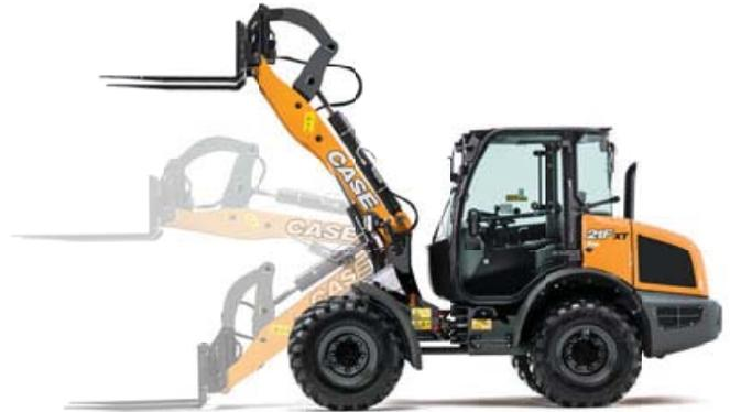
**XT** ist die beste Lösung für den Einsatz mit der Palettengabel. Hervorragende Sicht auf die Palette durch nur einen Hubzylinder. Optimale Nutzlast.
